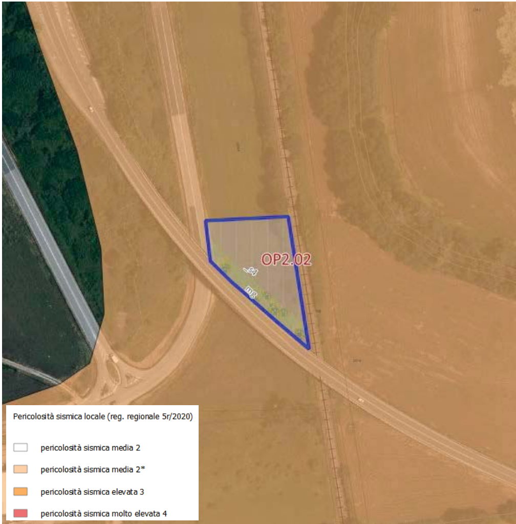
Figura 2- estratto pericolosità sismica locale
