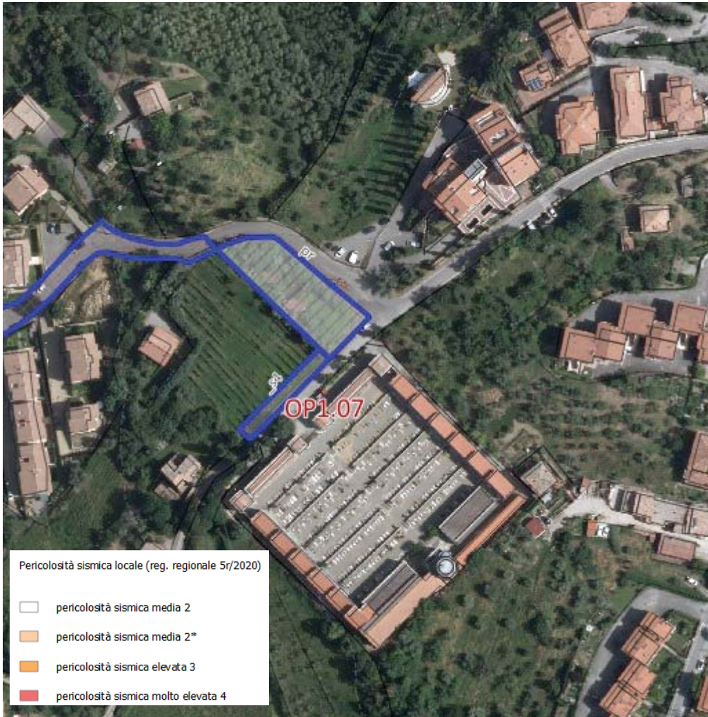
Figura 2- estratto pericolosità sismica locale
