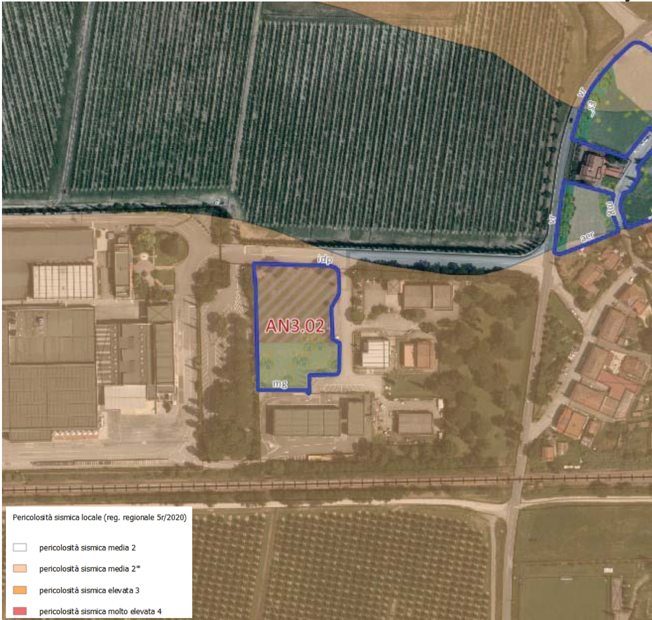
Figura 2- estratto di pericolosità sismica locale
