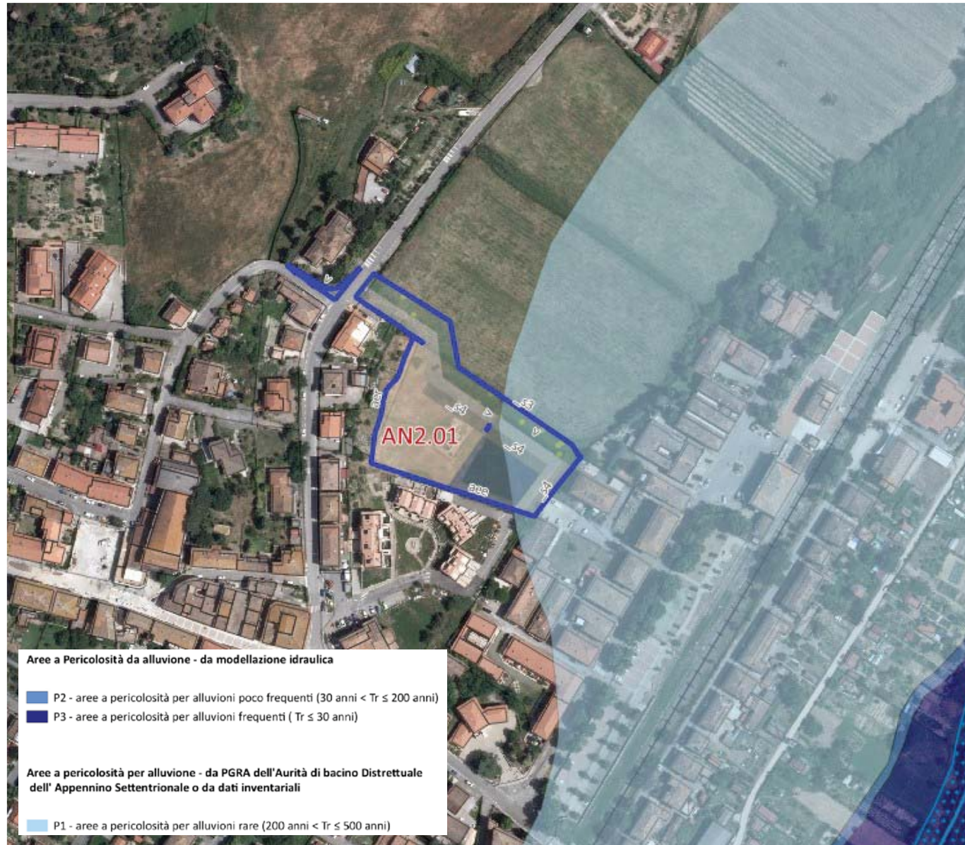
Figura 3- estratto pericolosità idraulica e PGRA
