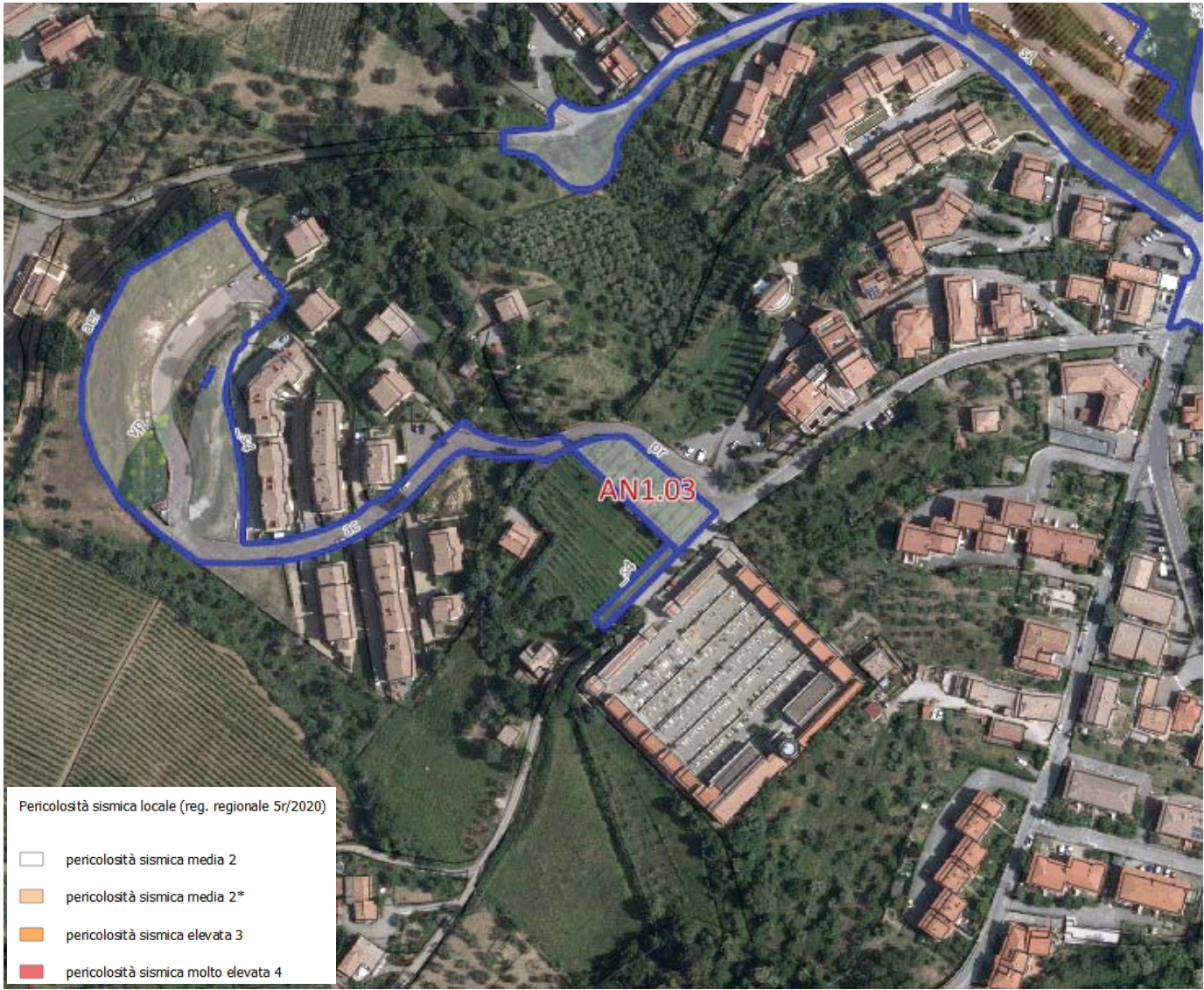
Figura 2-estratto di pericolosità sismica locale
